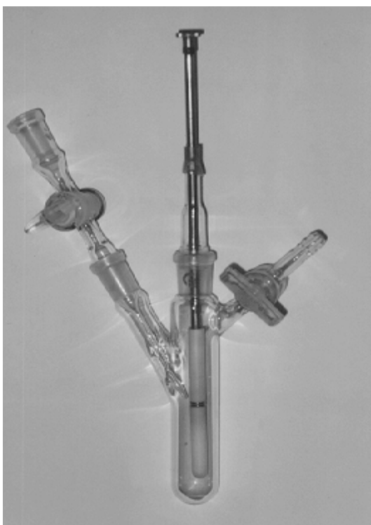
Abb. 36: Synthesezelle mit Doppelsegmentelektrode
