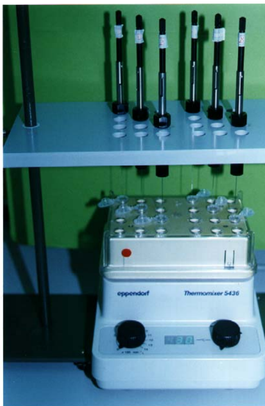
Abb. 2 SPME-Apparatur zur simultanen Probenextraktion.
