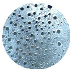
Abb. 21: Fotografie einer Silikonmembran, die bei der Herstellung mit 25% Triethylenglykol versetzt wurde
