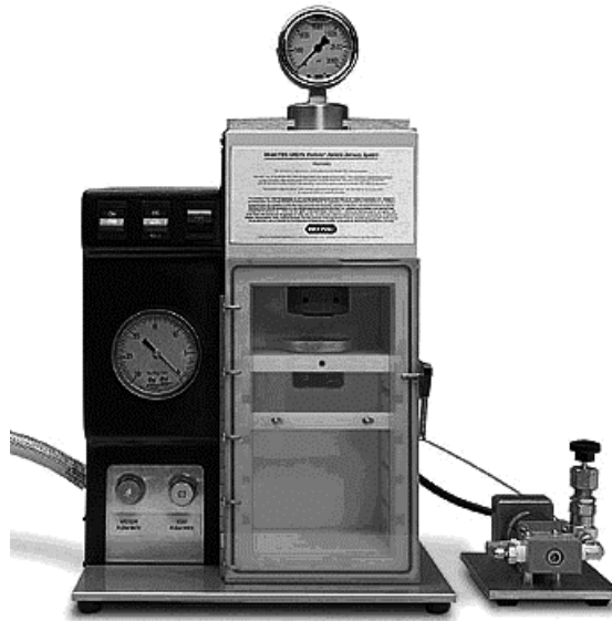
Abbildung 2.10: Die Genkanone wurde zur Transformation von RNAi- und Reporter-genkonstrukten in Gerstenblattsegmente verwendet Kanone (Model PDS-1000/He Biolistic Particle Delivery System; BioRad, Hercules, Kalifornien).
